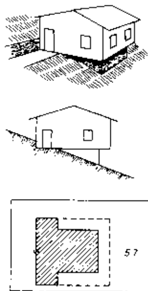
Fig. 31 - Fabbricato attraversato da un'area pubblica.
